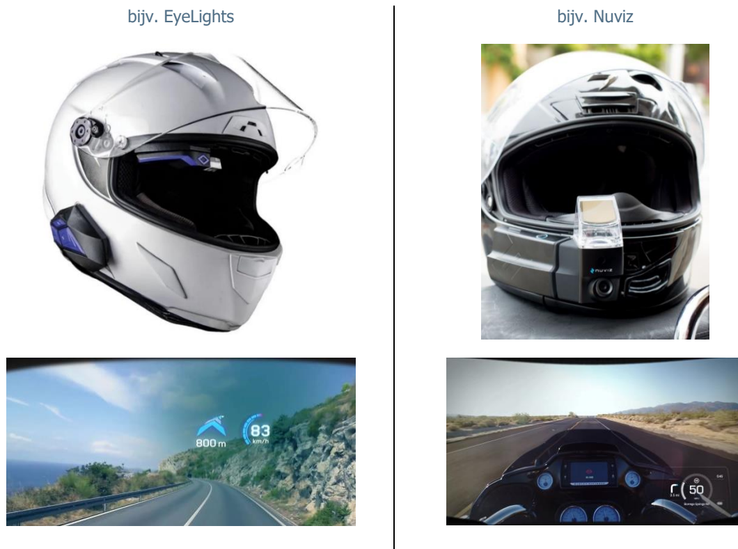
Figuur 6 – Plaats van het HUD in de helm en weergave van de informatie
